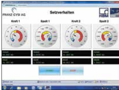
Elektronische Messung des Setzverhaltens einer Dichtung
