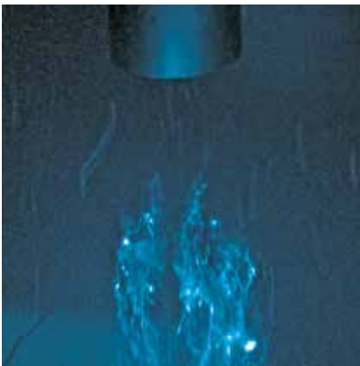
Demonstration von thermischen Schlägen und Kavitation
